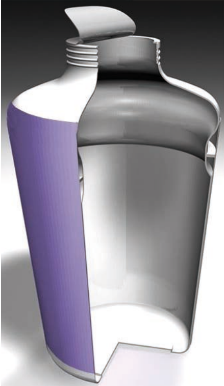
Abbildung 1: Schnittansicht einer in zwei Teilen thermogeformten Kunststoffflasche mit optimal ausgelegter und durch Etikette verdeckter Schweißnaht. Oben Schweißnaht vergrößert.
